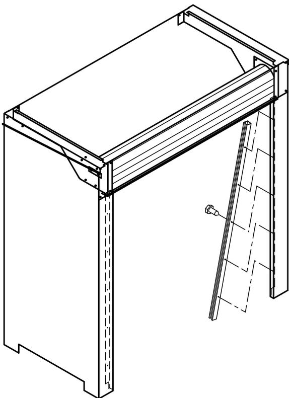
シャッターレールを取付した後、シャッターブラケットの六角ボルトを増し締めしてください。
