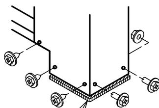
柱の側面は **タッピングビス** で締めます
