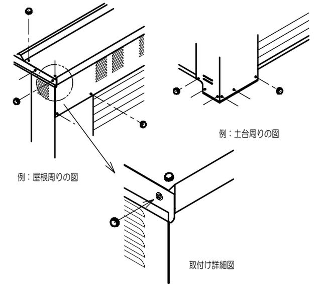
外側に付いているボルト及びタッピングビスの頭に全て取付けて下さい
