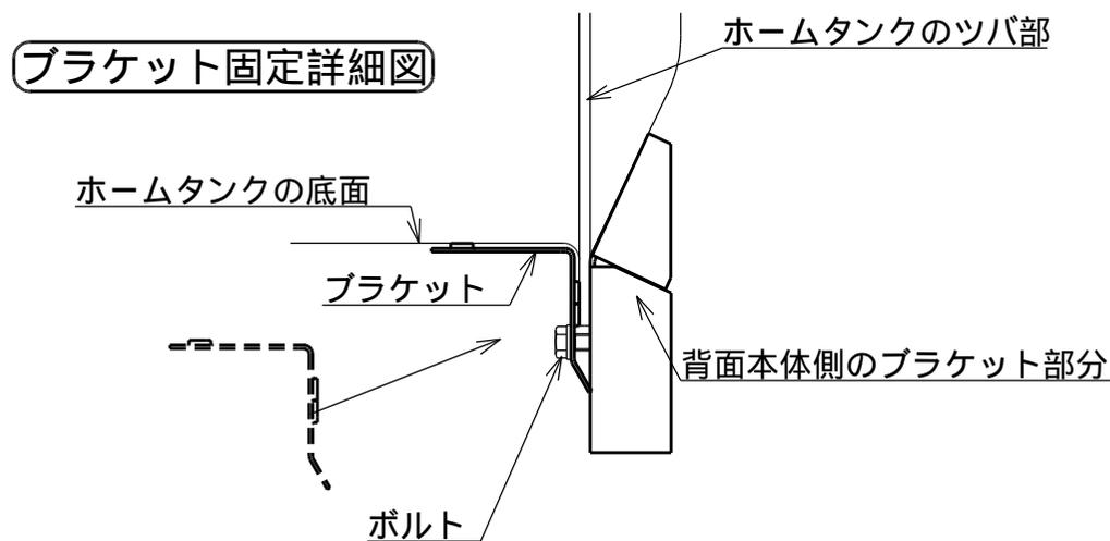
1. 正面、背面アダプタに接地ブラケットをボルト、ナット止めします。
