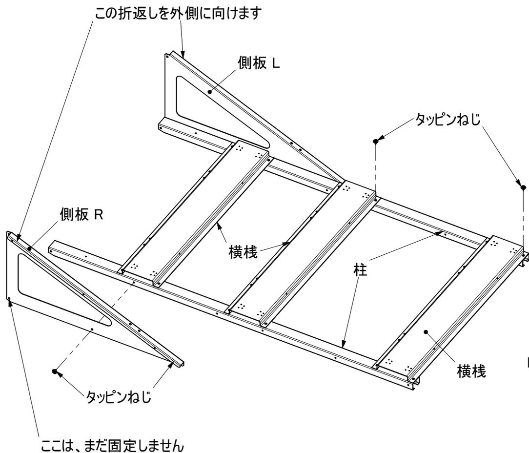
② 土台の立上りを外側にし、ボルト・ナットで固定します。
