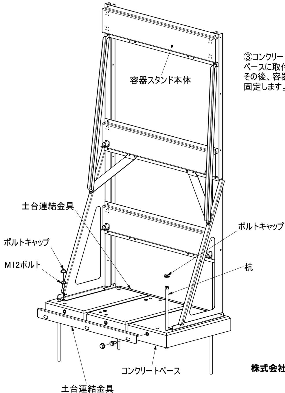
③コンクリートベースを3個並べ、土台連結金具をM12のボルトでベースに取付します。
