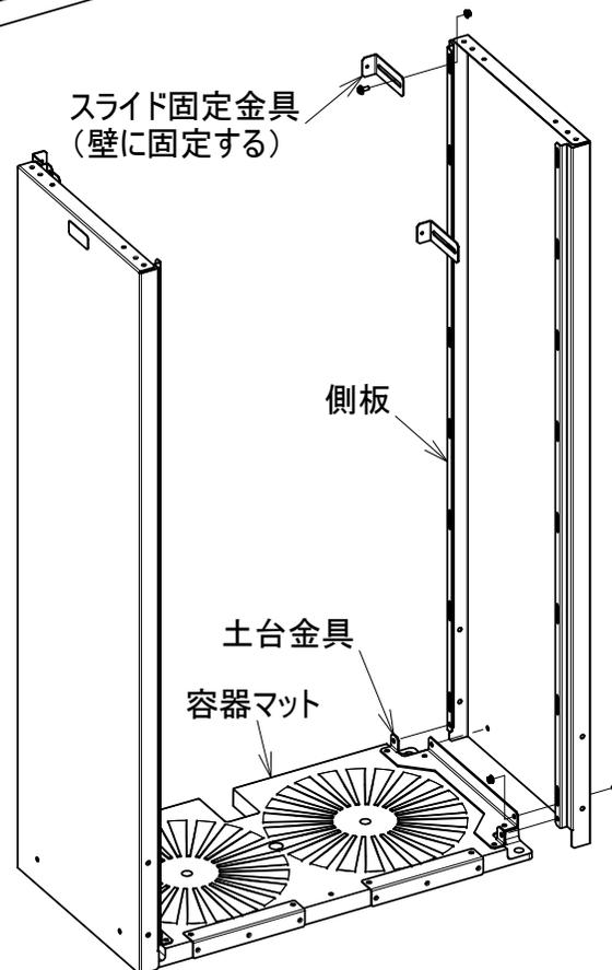
側板用補強金具を図の様に取付します。
