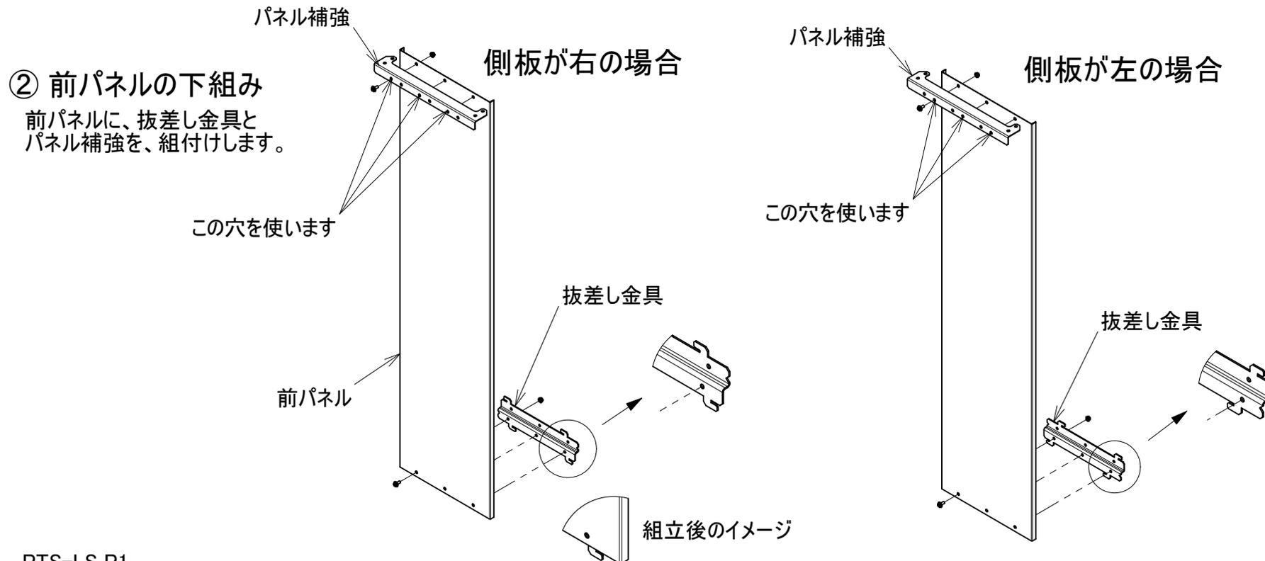
下図は側板が右側の図ですが、左側の場合も同様に施工して下さい(単純に勝手反対です)
