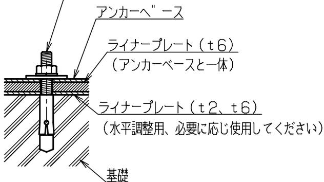
※アンカーボルトの取付はアンカーボルトに付属の説明書に従ってください。
