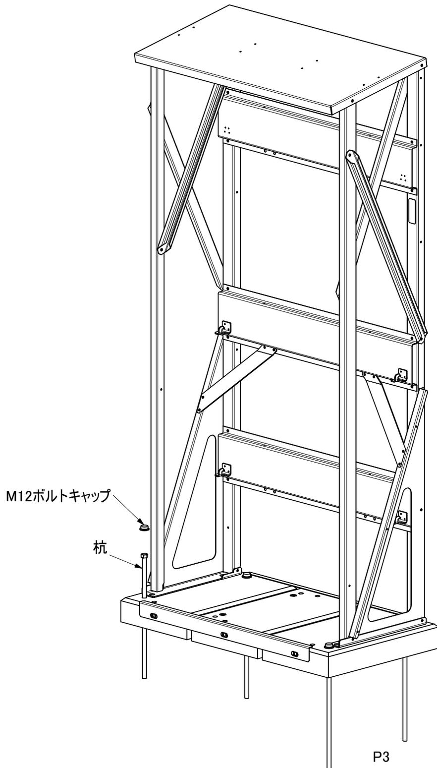
③ 左図のように組立されているか確認し、最後に杭を固定してください。
