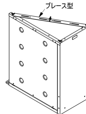
振れ止め金具の取付方は、壁に結合するストレート型と、側板に結合するブレース型があります(同じ部品を使用します)
