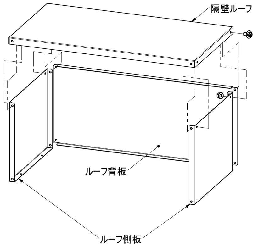
② 組立した隔壁ルーフを隔壁前カバーの上に載せ、ボルト・ナットで組立します。
