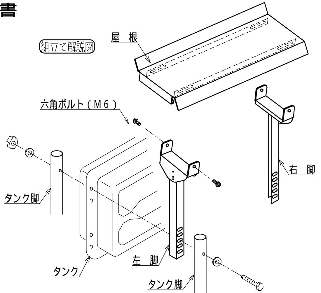
タンク脚を固定する六角ボルトで左右の脚を図の様に固定します。
