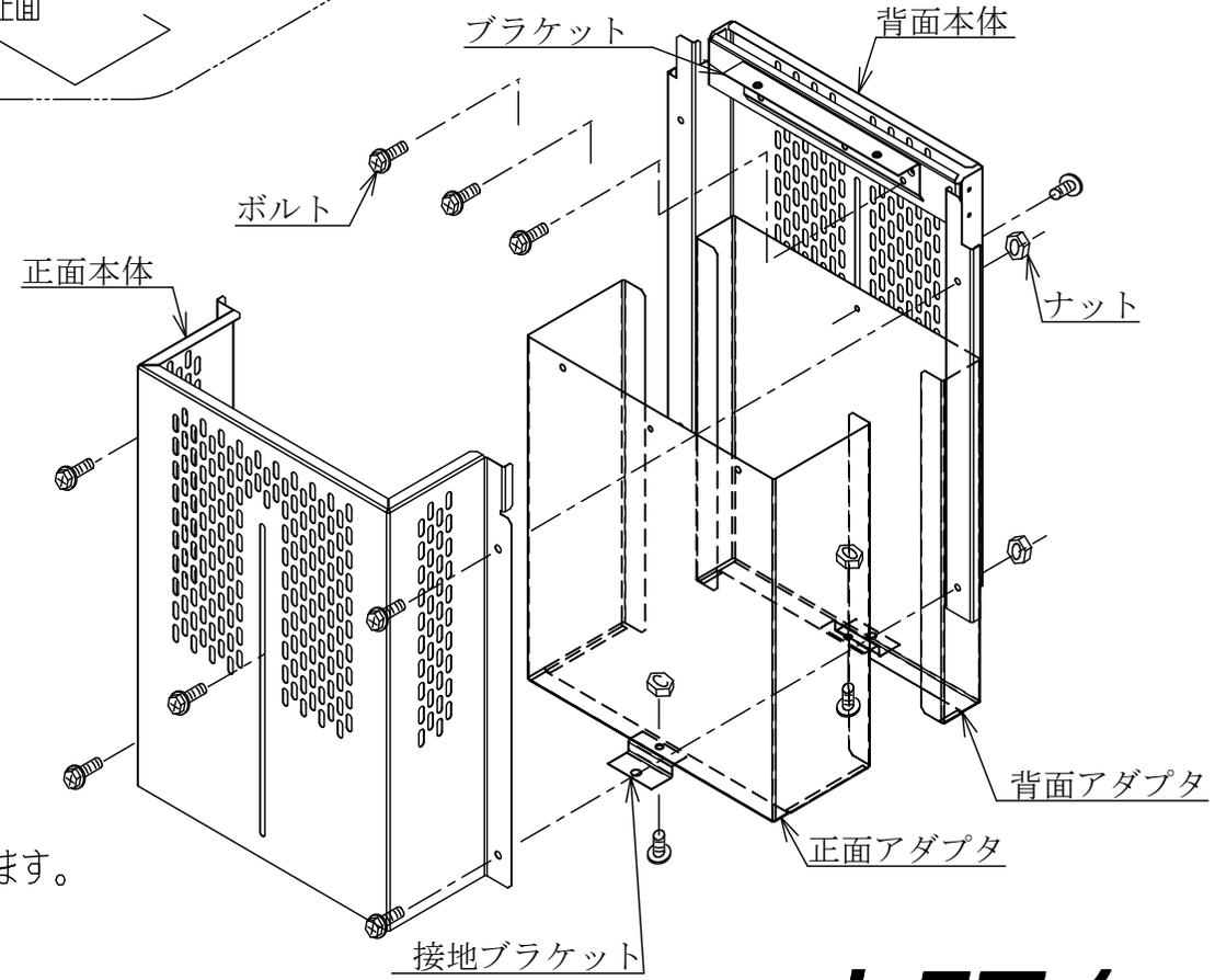
1. 正面、背面アダプタに接地ブラケットをボルト、ナット止めします。
