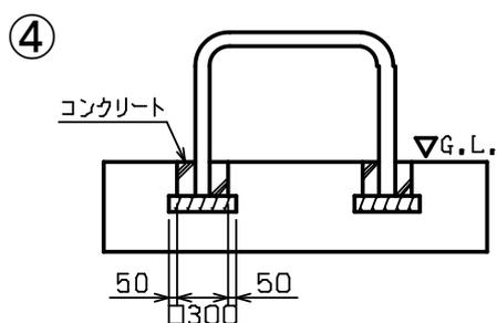
根巻き用の型枠をセットし、コンクリートを打設して下さい。
