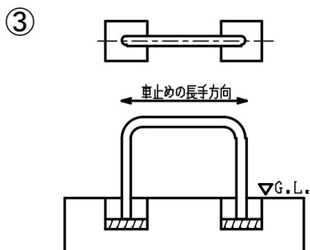
車止めを設置します。この時車止めの垂直度を確認してください。
