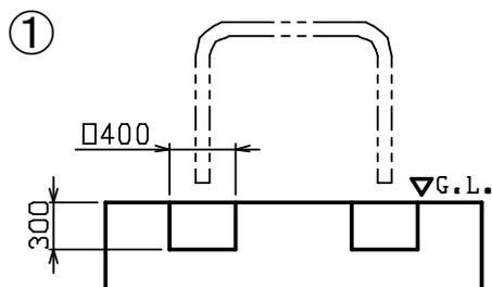
車止め設置場所に□400mm、深さ300mmの穴を掘ります。
