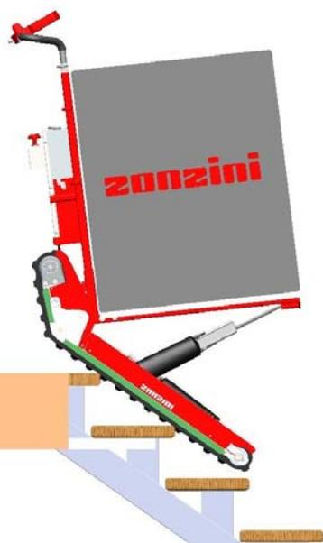
1. 最終段に差し掛かり、クローラメイン部分が階段の最終2,3段に台車が乗った状態で停止する。
