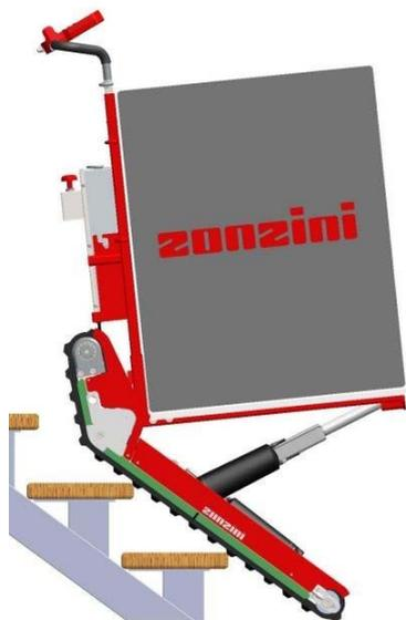
7. クローラの先端部分が地面から約 2-3cm 離れた時点で、オペレーターは荷台傾斜角度が移動に最適であるかどうかを確認する。
