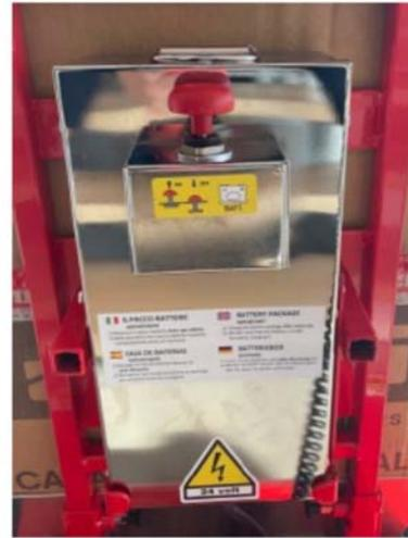
図 54 バッテリー充電器と階段昇降機のバッテリーボックス
