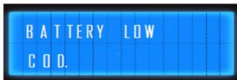
階段昇降機が階段上で作動中、ディスプレイに以下のように“BATT LOW(バッテリー残量低下)”のメッセージが表示される場合があります。このメッセージはバッテリー電圧が下がっていることを示し、出来るだけ早く充電が必要です。このメッセージに加えて、バッテリー品質を保つため利用可能な電圧に比例して減速します。
