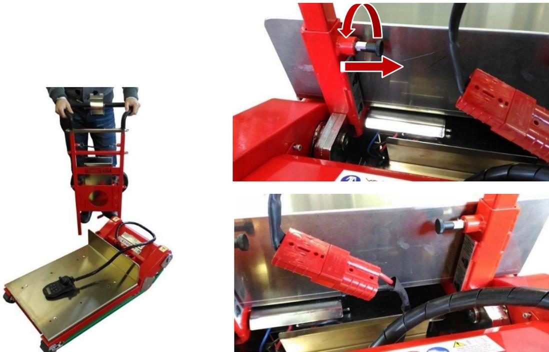
図 60 DOMINO 階段昇降機の輸送形態/操作ハンドルのロックピン
