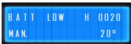
“BATT LOW(バッテリー残量低下)”のメッセージ表示後、更に階段昇降機の使用を継続すると、“BATTERY EMPTY(バッテリー残量なし)”のメッセージが表示されます。これは、バッテリーに損傷を与えずにこれ以上の使用が不可能であることを示し、階段昇降機を停止します。
