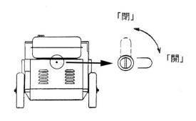
扉を開ける時は、扉に付いている「錠前」の溝を 10円硬貨などで回してください。右へ回すと 「開」、左へ回すと「閉」となります。 (掻き出し棒の先端でも回せます。)
