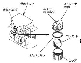
燃料フィルターに水、ゴミ等が溜まると、電磁バルブから振動音が出たり、点火不良をおこすことがあります。15日に1回位の割合で点検・掃除を行ってください。
