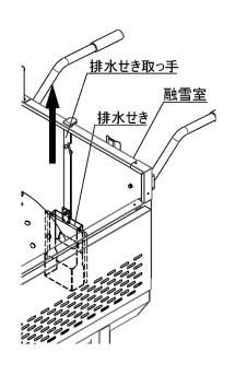
1. 排水せきを上げ、融雪プレート水留め部の排水栓を抜いて排水してください。排水後は排水栓を元の位置に押し込んで下さい。
