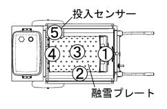
**重要** 投入開始時は、左図の①→②→③→④→⑤の順に 満杯にしてからバーナが燃焼するように投入する と効率良く作業が行えます。
