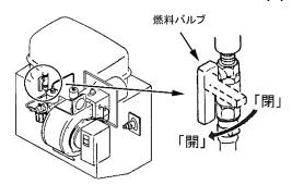
燃料タンク左側下(バーナ室側)についている 燃料バルブのレバーを下方へ回すと、バルブが 開いて灯油が流れます。
